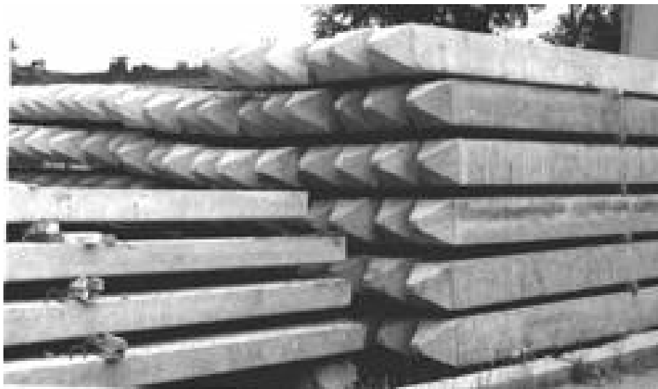
Рис. 4.6. Складиrowание свай из мелкозернистого бетона.
